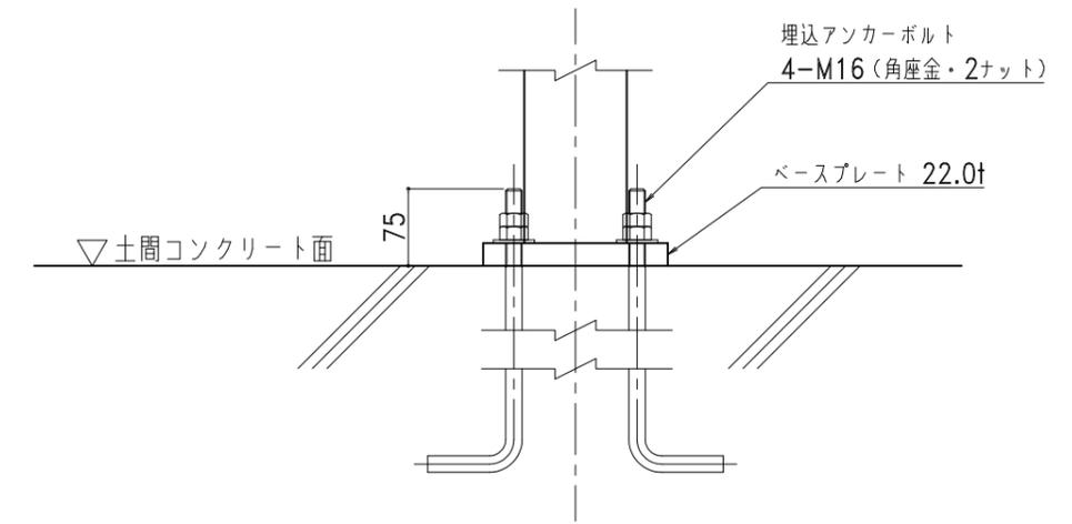
連棟用中間柱アンカー納まり図 1/8
